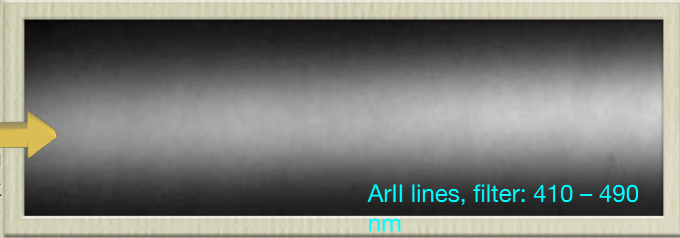
свечение аргона, индуцированное ионным пучком
